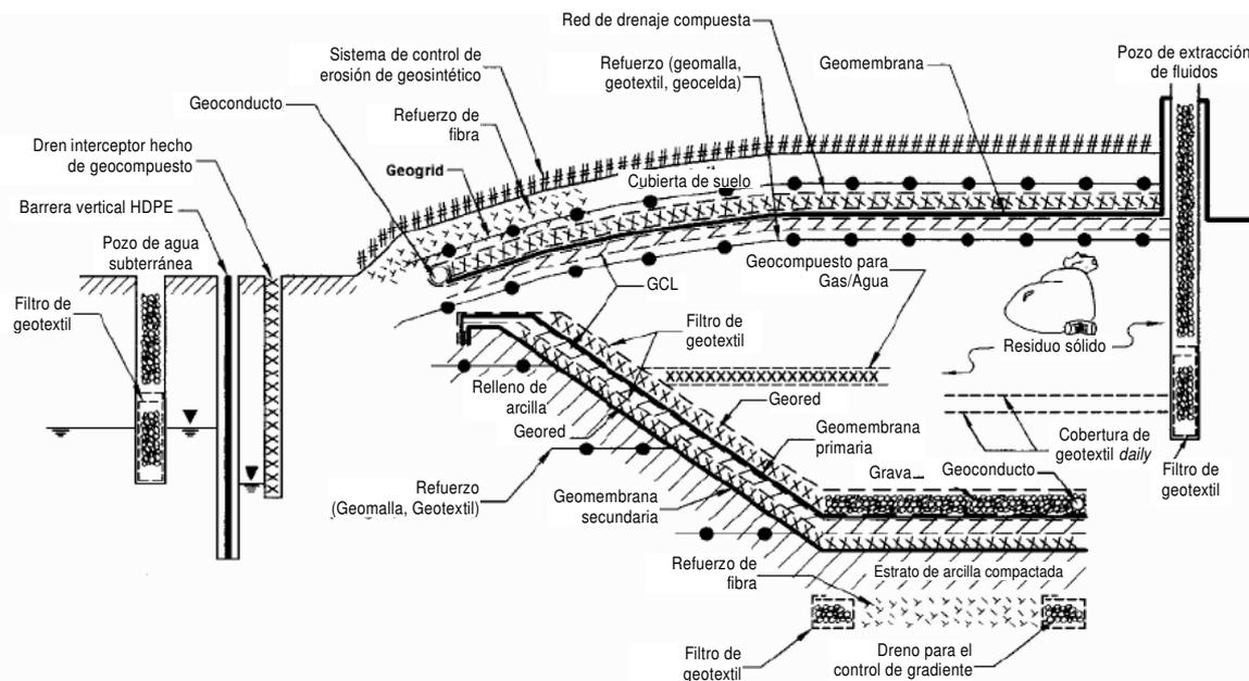
El sistema de revestimiento de base ilustrado en la figura arriba es un sistema de doble revestimiento compuesto. Este incluye un compuesto Geomembrana/GCL como sistema primario de revestimiento y un compuesto geomembrana/arcilla compactada como
